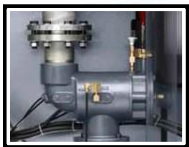
Válvula de controle
